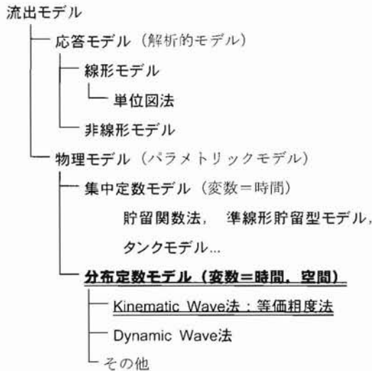
図 3-2 流出モデル（流出計算法）の分類 8)
